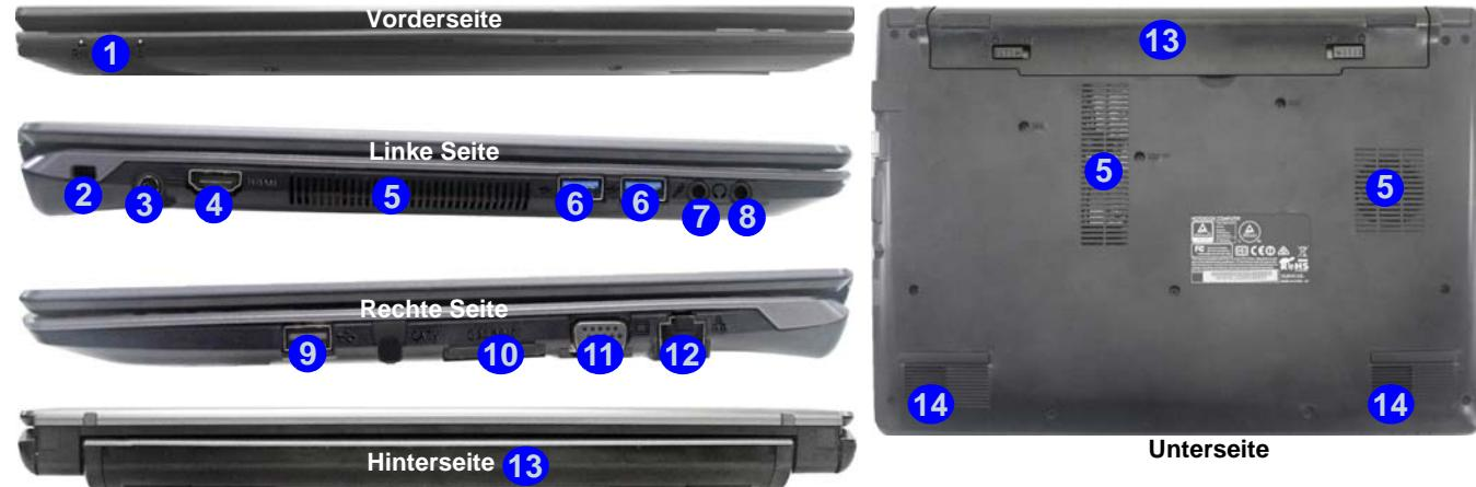
Abb. 6 - Ansicht von vorne, links, rechts, hinten und unten (Modell A)
