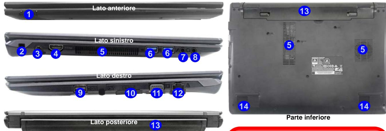
Figura 6 - Vista anteriore, sinistra, destra, posteriore e inferiore (Modello A)
