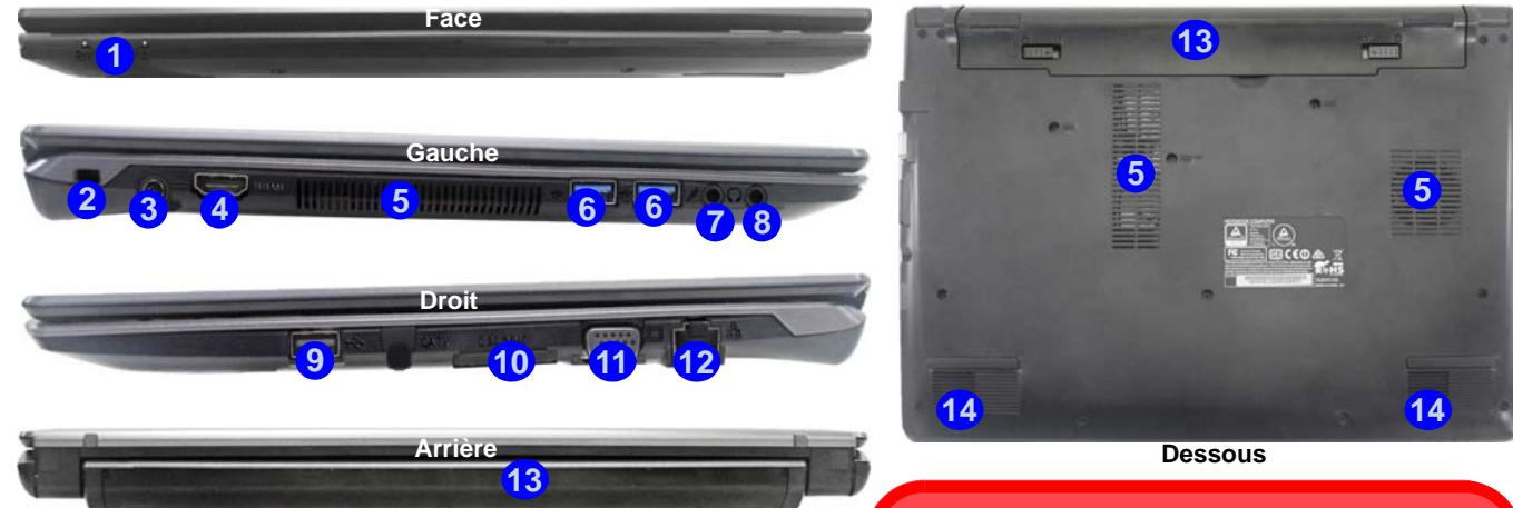
Figure 6 - Vues de face, gauche, droite, arrière & dessous
