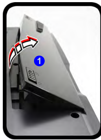
Abb. 27 - Herausnehmen des Akkus und einsetzen der USIM-Karte
