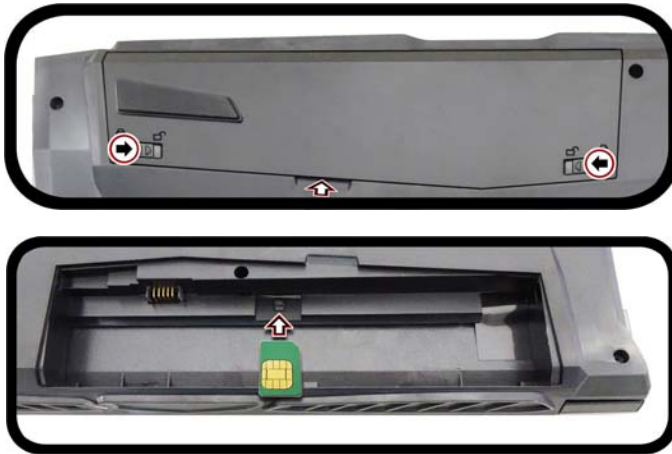
Abb. 29 - Herausnehmen des Akkus und einsetzen der USIM-Karte
