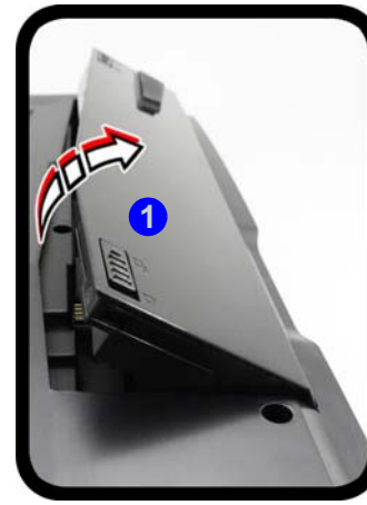
Figure 29 - Retirer la batterie et insérer la carte USIM
