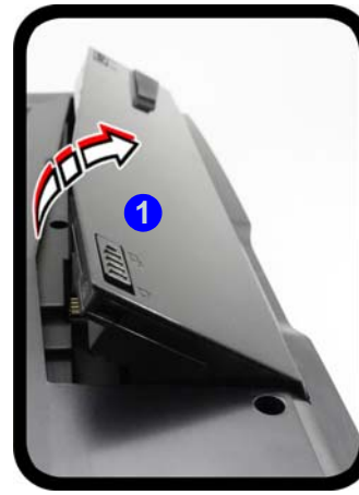
Abb. 29 - Herausnehmen des Akkus und einsetzen der USIM-Karte
