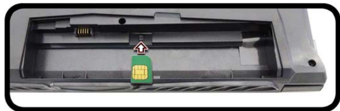
Figura 29 - Quitar la batería e insertar la tarjeta USIM
