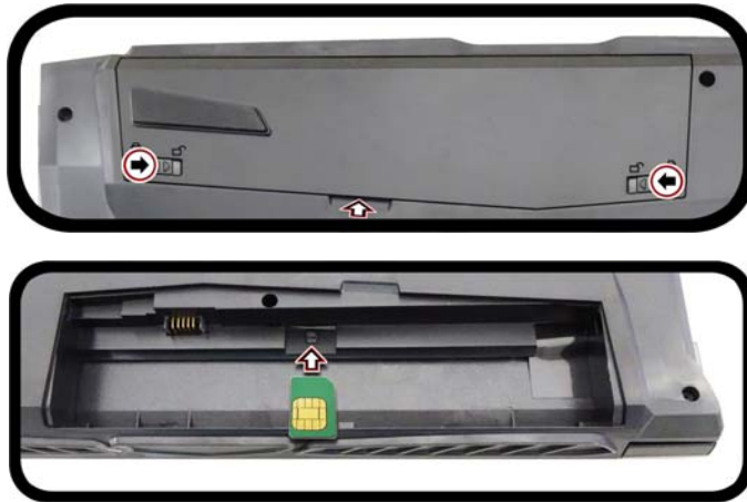
Figura 31 - Rimozione della batteria e inserimento della carta USIM
