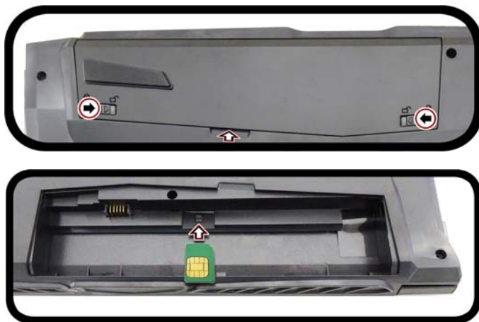
Figura 31 - Quitar la batería e insertar la tarjeta USIM
