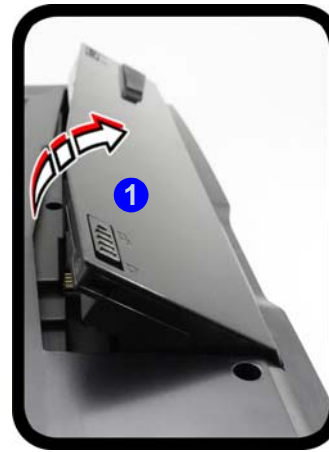
Abb. 31 - Herausnehmen des Akkus und einsetzen der USIM-Karte
