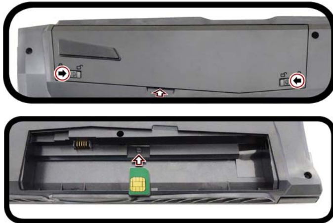
Abb. 31 - Herausnehmen des Akkus und einsetzen der USIM-Karte
